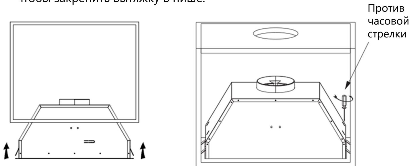
5. Для эксплуатации прибора в вытяжном режиме установите гофро-трубу на воздуховод с антивозвратным клапаном и выведите её в вентиляцию. Для режима рециркуляции пропустите этот шаг. Установка завершена.
