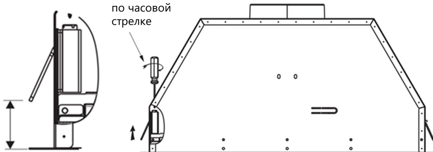
4. Поместите вытяжку в кухонный шкаф. С помощью отвёртки поверните четыре винта, регулирующие крепления, против часовой стрелки так, чтобы закрепить вытяжку в нише.
