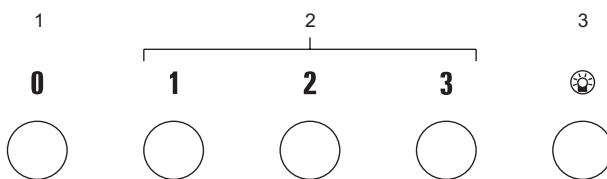
Работа вытяжки контролируется при помощи совмещенного переключателя "1" – включение первой рабочей скорости устройства,
