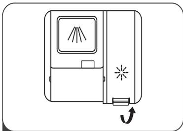
**1** Откройте вверх крышку отсека ополаскивателя.
