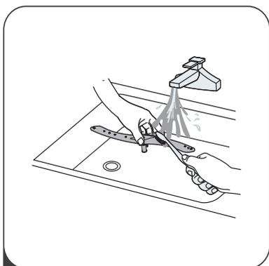
**3** Промойте сопла с использованием мягкой щетки. Установите в обратной последовательности после промывки.
