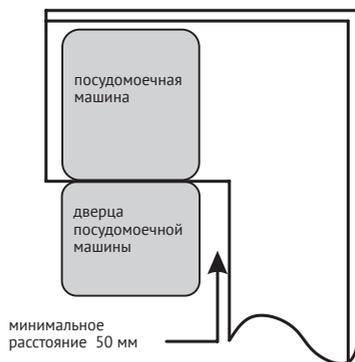
В зависимости от того, где находится ваша электрическая розетка, вам может понадобиться вырезать отверстие на задней стенке шкафчика.
