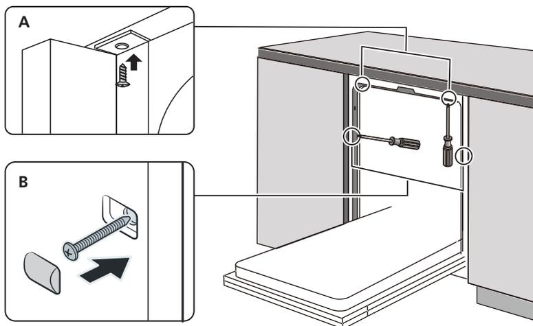
8. Отрегулируйте натяжение дверных пружин с помощью крестовой отвертки, вращая по часовой стрелке, чтобы затянуть левую и правую дверные пружины. Невыполнение этого требования может привести к повреждению вашей посудомоечной машины (Шаг 11).
