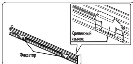
На каждой телескопической направляющей предусмотрены фиксаторы, которые позволяют снимать ее для очистки или изменения положения. Для этого необходимо снять боковой бегунок, следуя инструкции в разделе «Демонтаж проволочных направляющих».
