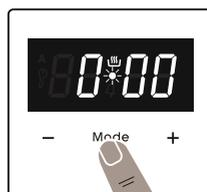
2. Отрегулируйте время при помощи кнопок «+» и «-».
