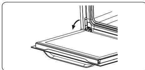
2. Откройте опорный подвес (а) при помощи отвертки до упора.
