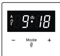
Когда таймер достигнет нулевого значения, духовой шкаф выключится и прозвучит предупреждающий звуковой сигнал. Загорится символ «А». Поверните обе ручки духового шкафа в положение «0» и нажмите любую кнопку на таймере, чтобы отключить звуковой сигнал. Нажмите и удерживайте кнопку «М» в течение двух секунд, пока не исчезнет символ «А», и таймер переключится обратно в ручную функцию.
