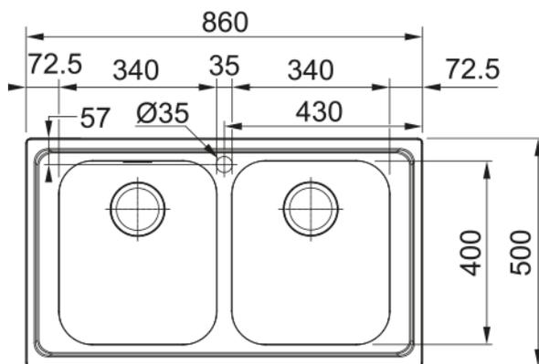
Мойка SRX 620, 860x500 мм, без крыла, нерж.сталь, 3 1/2", вентиль, отверстие под смеситель, скрытый перелив, короб
