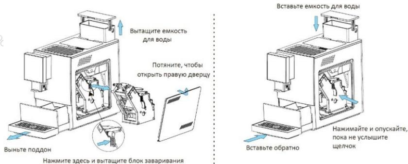
**Внимание!** При переустановке блока заваривания в правильное положение раздастся щелчок; если его нет, снова снимите блок заваривания и установите на место.
