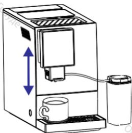
2. Один конец трубки для всасывания молока соедините со взбивателем, а другой конец опустите в молоко (при необходимости используйте емкость для молока).
