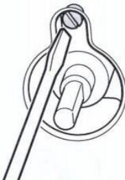
Zünden Sie nach Abschluss des Umbaus die Brenner der Reihe nach an und stellen Sie durch Lösen des Knopfes am Bedienfeld, durch Anziehen oder Lösen der Schraube am Gasventil (12,4 Hahn) oder im Ventilschaft die Länge der Brennerflamme ein.
