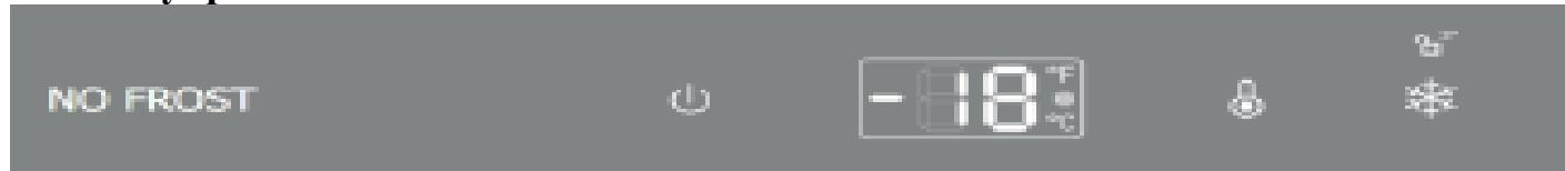
После первого включения питания или перезапуска после сбоя питания морозильная камера будет работать при температуре -18°C. Измените температуру или функции, нажмите кнопку в течение 3 секунд, чтобы разблокировать; и панель управления будет повторно заблокирована после 30 секунд бездействия.
