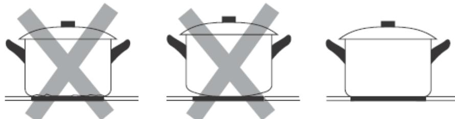
Убедитесь, что поверхность дна посуды гладкая, плотно прилегает к поверхности варочной панели, а диаметр дна соответствует диаметру варочной зоны. При использовании посуды с дном большего диаметра будет расходоваться большее количество энергии. Если Вы используете посуду с меньшим диаметром дна, то эффективность использования энергии может быть меньше, чем ожидалось. Всегда ставьте посуду по центру варочной зоны.
