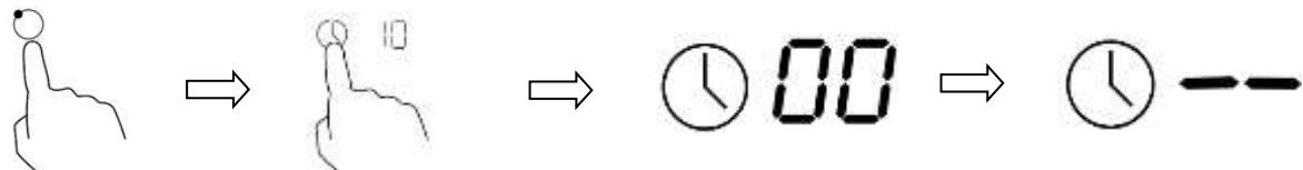
6. По истечении установленного времени выбранная варочная зона автоматически отключится. Раздастся однократный звуковой сигнал, на дисплее загорится «--».
