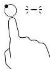
4. Установите уровень мощности при помощи кнопок «+» и «-» ИЛИ проведите пальцем по кнопке управления «—» или просто нажмите в любой точке на кнопке управления «—».
