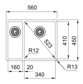
Мойка BXX 260/160-34-16, 560x450 мм, без крыла, нерж.сталь, 31/2", вентиль, скрытый перелив, без отверстия под смеситель, короб
