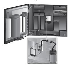
Опустите защелку слева от устройства разлива напитков вниз и снимите устройство разлива напитков, потянув его вперед.
