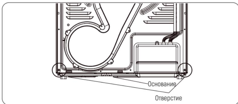
4. Отрегулируйте высоту ножек сушильной машины так, чтобы ограничитель высоты можно было вставить, а высота зазора составляла 11,5 мм.
