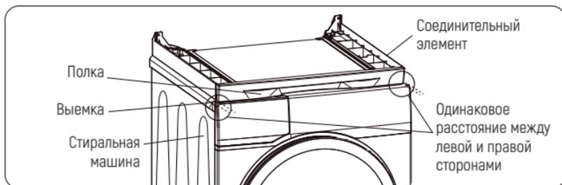
2. Закрепите соединительный элемент и верхнюю крышку стиральной машины 4 саморезами.
