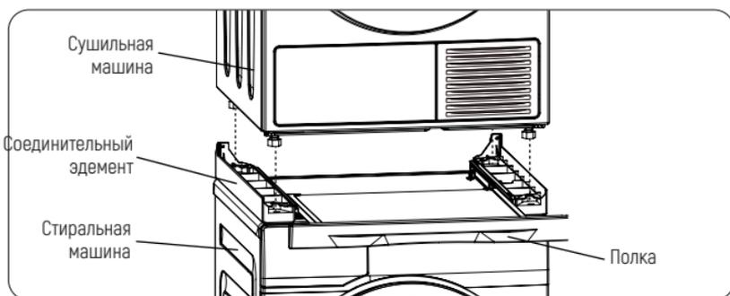
7. Возьмите 2 винта, которые были удалены. Вкрутите винты в отверстия, соединяющие кронштейн и нижнюю часть задней панели сушильной машины, а затем закрепите их.
