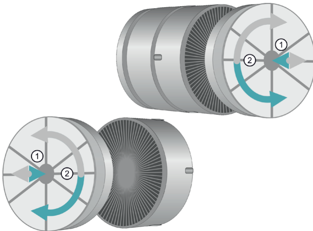
Рис. 14 Установка угольного фильтра
