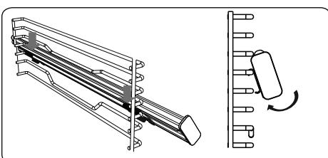
Чтобы закрепить телескопическую направляющую, повесьте верхние фиксаторы на опорный стержень бокового держателя. Затем одновременно нажмите на нижние фиксаторы до тех пор, пока они не зафиксируются в стержне бокового держателя с характерным щелчком. Для демонтажа выполните те же действия в обратном порядке, при этом придерживая переднюю часть направляющей.
