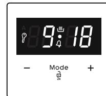
Когда время истечет, таймер подаст звуковой сигнал, а на экране начнет мигать символ . Для выключения звукового сигнала можно нажать на любую кнопку. Нажмите и удерживайте кнопку «M» в течение двух секунд, символ исчезнет и отобразятся часы.
