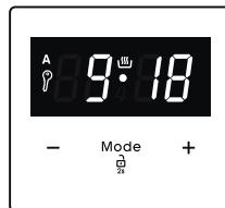
Когда таймер достигнет нулевого значения, духовой шкаф выключится и прозвучит предупреждающий звуковой сигнал. Загорится символ «A». Поверните обе ручки духового шкафа в положение «0» и нажмите любую кнопку на таймере, чтобы отключить звуковой сигнал. Нажмите и удерживайте кнопку «M» в течение двух секунд, пока не исчезнет символ «A», и таймер переключится обратно в ручную функцию.
