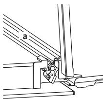
3. Закройте дверцу почти до упора и снимите ее, потянув на себя.
