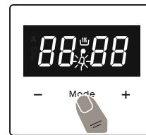
После настройки времени обе ручки управления должны находиться в выключенном положении, чтобы прибор перешел в режим ожидания.
