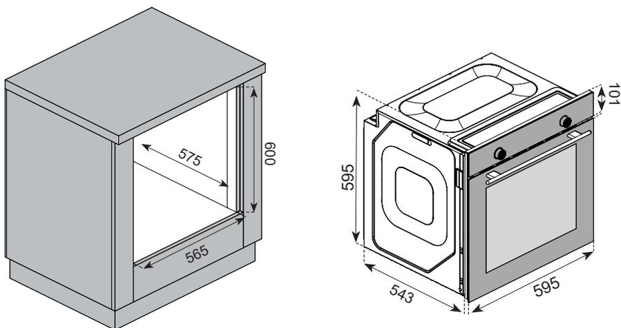
Панели кухонного гарнитура, которые находятся рядом с духовым шкафом, должны быть изготовлены из материала, выдерживающего температуру не менее **120 °С**. На покрытие или шпон кухонной мебели необходимо нанести термостойкий клей, рассчитанный на температуру **100 °С**. Пластмассы или клеи, которые не выдерживают таких температур, расплавятся и деформируются.
