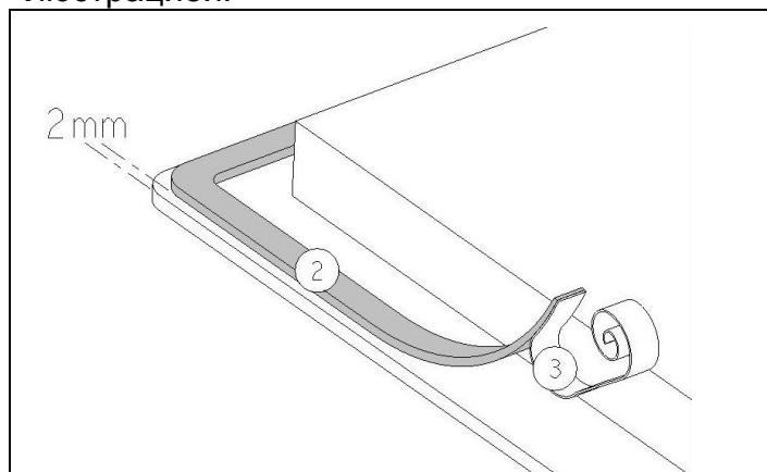
Приклейте уплотнитель (2) на расстоянии 2 мм от внешнего края стеклокерамической поверхности после удаления защитной ленты (3).
