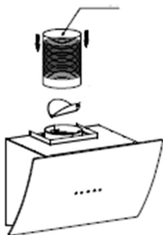
3. Извлеките вытяжку из коробки и аккуратно поставьте на горизонтальный рабочий стол. Установите выходную трубу 120 мм к выходному патрубку и убедитесь, что она плотно присоединена.
