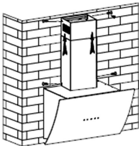
8. Выдвиньте внутреннюю часть короба на высоту саморезов, подвесьте короб на саморезы за фиксирующую скобу. По отверстиям скобы отметить и просверлить 2 отверстия диаметром 8 мм и глубиной 75~85 мм. Далее следует выровнять фиксирующую скобу с отверстиями и затянуть саморезами 5x60.
