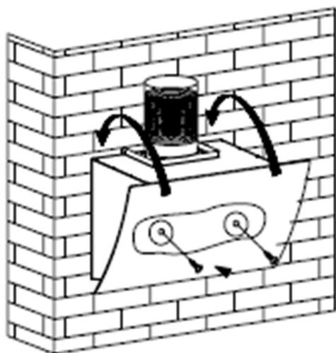
7. Подвесьте вытяжку на саморезы, выровняйте её по горизонту и затяните саморезы отверткой.
