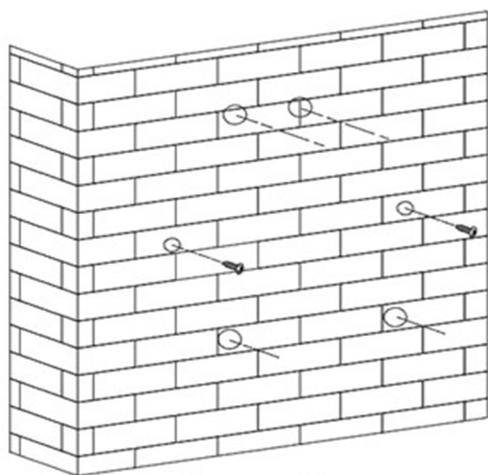
2. Наметьте на стене и просверлите отверстия диаметром 8 мм и глубиной 75~85 мм. Вставьте в отверстия дюбеля. Затяните саморезы 5x60 мм, в дюбели, оставив расстояние между стеной и головкой самореза в 5 мм
