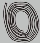
Расположите уплотнитель из комплекта поставки вдоль нижнего края варочной поверхности так, чтобы его концы заходили один на другой.
