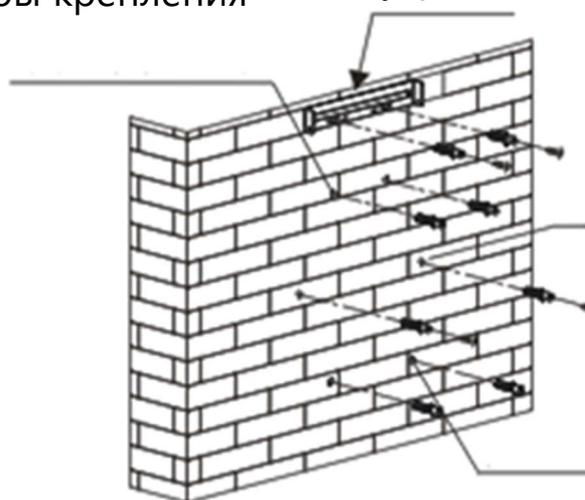
Отверстия для крепления корпуса вытяжки
