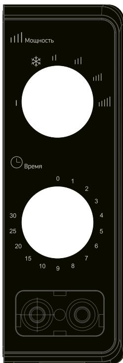
Панель управления состоит из двух ручек. Одна из них - регулятор времени, а другая - регулятор мощности.
