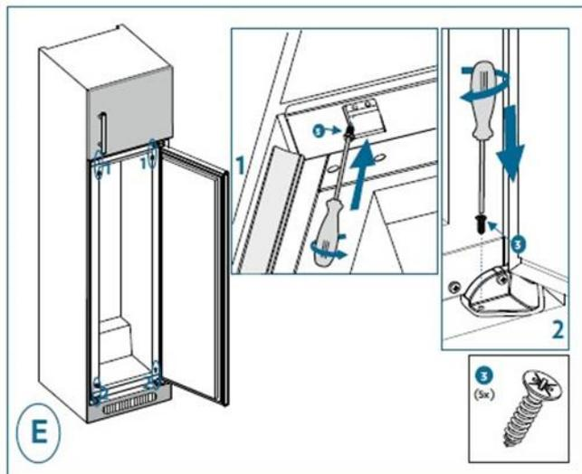
5. Привинтите направляющую в отверстия на боковой стороне устройства. Вставьте полозья в направляющую и привинтите их к дверце. Открутите направляющую, чтобы привинтить последний винт полозьев к дверце. Затем прикрепите крышку полозьев к полозьям. Снова привинтите направляющую к устройству, вставив в нее полозья.
