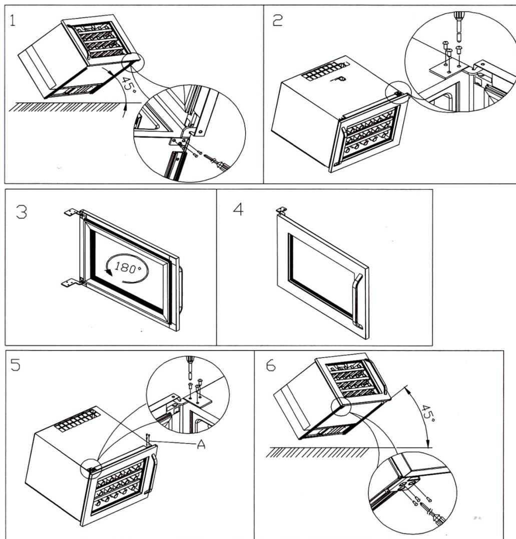
1. Накланите шкаф на  $45^\circ$  и выкрутите болты на нижней петле (рис.1)
