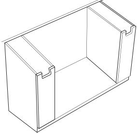
取り付けられているシンクの実際のサイズを測定して、キャブ開口部の寸法とサポートフレームの位置を決定します。
