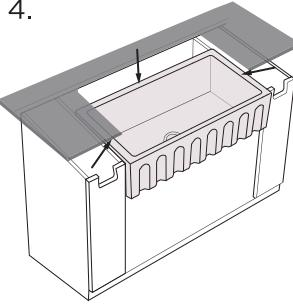
カウンタートップと接触するシンクの部分にシーラントを塗布します。
