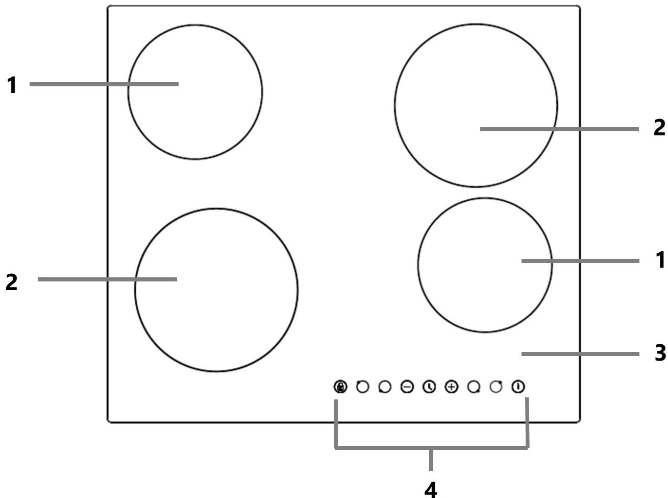
1. Варочные зоны  $\varnothing 165$  мм – мощность (максимум) 1200 Вт.
