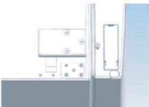
4. Ослабьте 1 винт как показано на рисунке, чтобы снять заглушку на верхней стороне прибора. Снимите маленькую торцевую заглушку на двери и извлеките дверную втулку и кабельное соединение.
