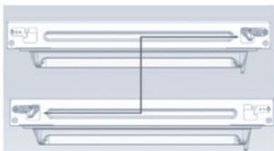
2. Снимите винты со стопора, как показано на рисунке, и установите его на противоположной стороне двери.
