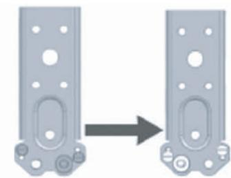
3. Снимите ось и два стопора с нижней петли и установите их в положение, как показано на рисунке ниже.
