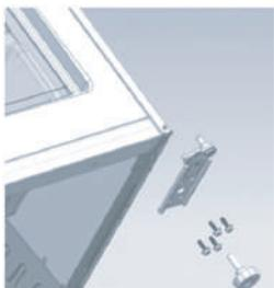
3. Снимите регулируемые передние ножки под нижней петлей. Затем ослабьте 4 винта, удерживающих нижнюю петлю, и снимите ее с холодильника. Снятие дверей завершено.
