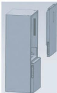
6. Поднимите дверцу холодильника, примерно, на 50 мм, чтобы снять ее с прибора.
