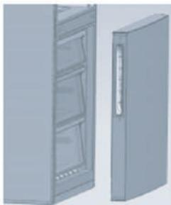
2. Поднимите дверцу морозильной камеры, примерно, на 50 мм, чтобы ее можно было снять.
