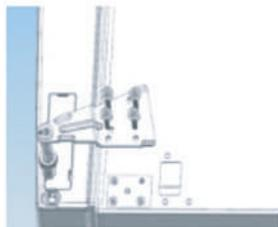
3. Вставьте дверную петлю и кабельное соединение в
