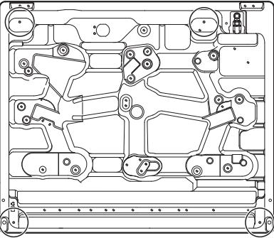
Вкрутите крепежные скобы в отмеченные отверстия, чтобы правильно закрепить варочную панель на встроенной конструкции.
