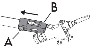
6. Отвинтите винт "A" и протолкните до упора регулятор воздуха "B".
