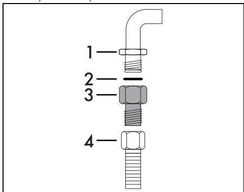
Аккуратно привинтите фитинг 3 к газовому патрубку 1 (резьба  $\frac{1}{2}$  дюйма ISO 228-1) прибора, проложив прокладку 2 из комплекта поставки. Нанесите изоляционный материал на резьбу патрубка 3, а затем заверните гибкий стальной шланг 4 на патрубке 3.
