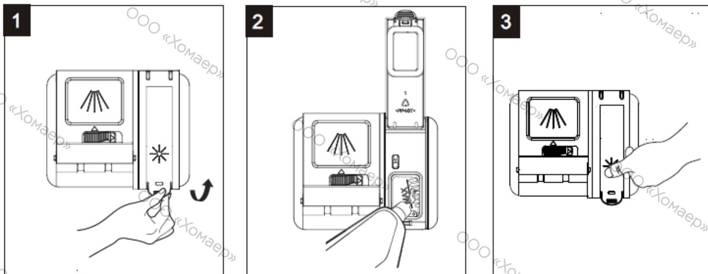
1. Поднимите ручку и снимите крышку дозатора ополаскивателя.
