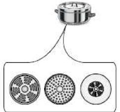
на индукцию, нержавеющая сталь (хромистая сталь). Индукционная панель не будет работать с посудой из обычной нержавеющей стали, стекла, керамики, меди и алюминия, если дно посуды не выполнено из ферро магнитного материала.
