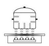
Тепло образуется посредством магнитной индукционной катушки, которая создает магнитное поле. Под ее действием посуда нагревается и тепло от кухонной посуды передаётся пищевому продукту.
