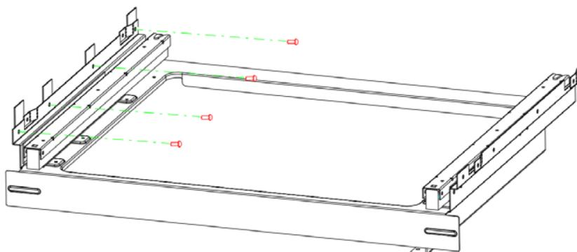
Шаг 1: установите соединительные кронштейны для направляющих – зафиксируйте винтами сбоку.
