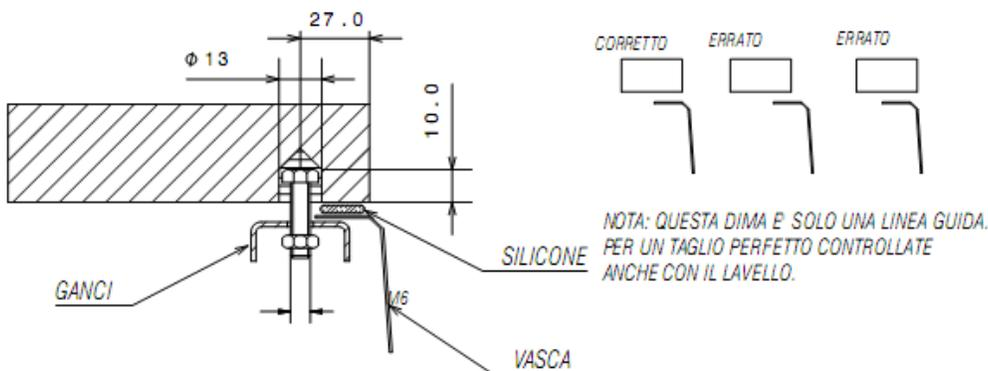
2) Determinare la posizione delle staffe di fissaggio. Eseguire i fori utilizzando gli utensili adatti al materiale del top.
